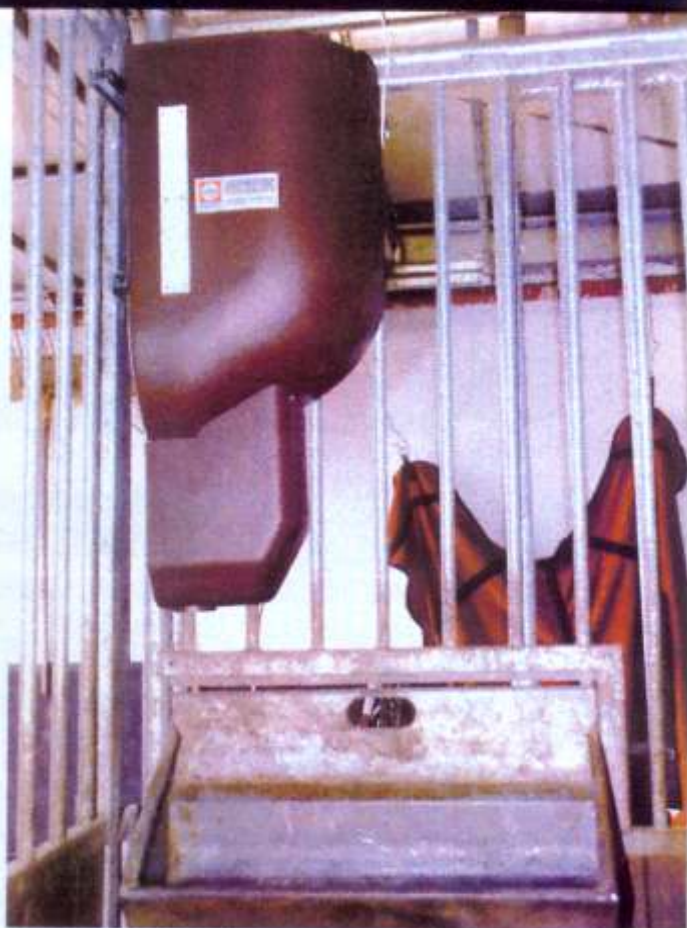
Das Dosiergerät hängt über dem Futtertrög und füllt diesen in programmierten Intervallen mit entsprechenden Raufutter-Portionen.
